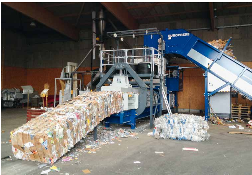
Kanalballenpresse 80 Tonnen (Presskraft) für Materialien wie Karton, Folie, PET und Kunststoffe.
