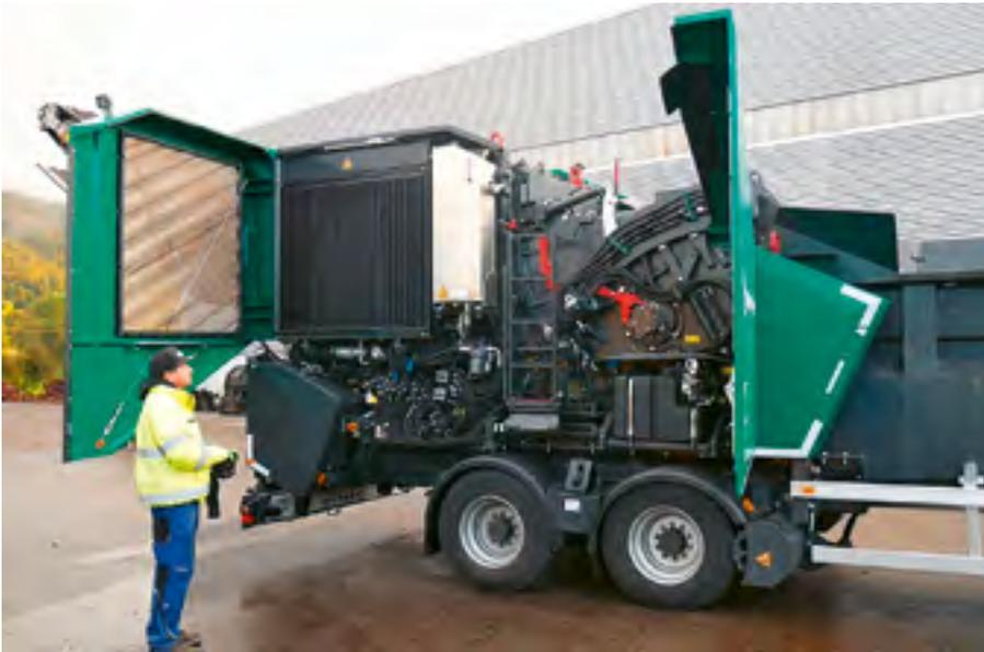
**Die Bedienung der Maschine erfolgt mittels Fernsteuerung. Elektro-hydraulisch kann das Rotorgehäuse, der Siebkorb sowie die Einzugswalze geöffnet werden**
