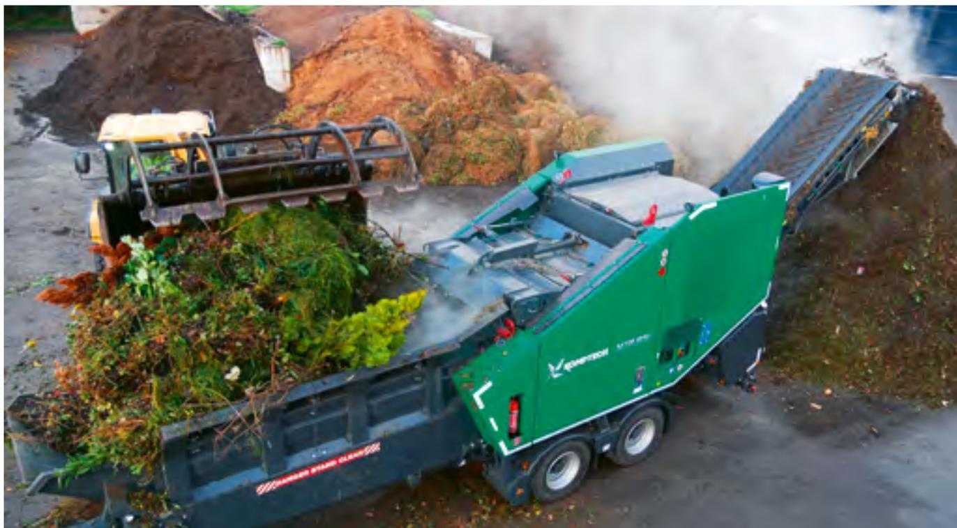
Der «Axtor 4510» mit 462-PS-Motor und 19 Tonnen Gesamtgewicht kann sowohl für das Hacken von Holz wie auch für das Schreddern von Grünmasse eingesetzt werden. Bilder: H. Röthlisberger
