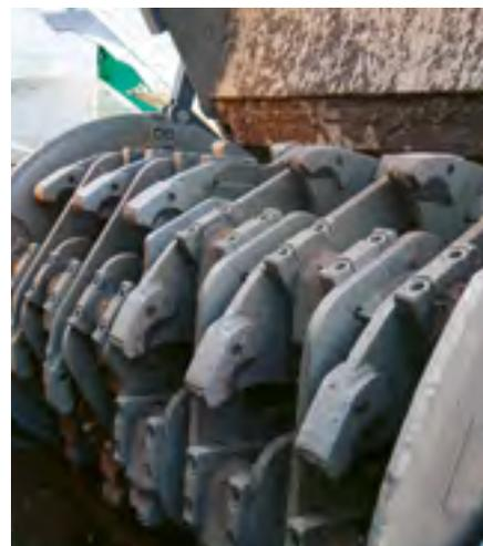
**Die Hacktrommel kann mit 32 freischwingernden oder mit 32 feststehenden Werkzeugen ausgerüstet werden.**
