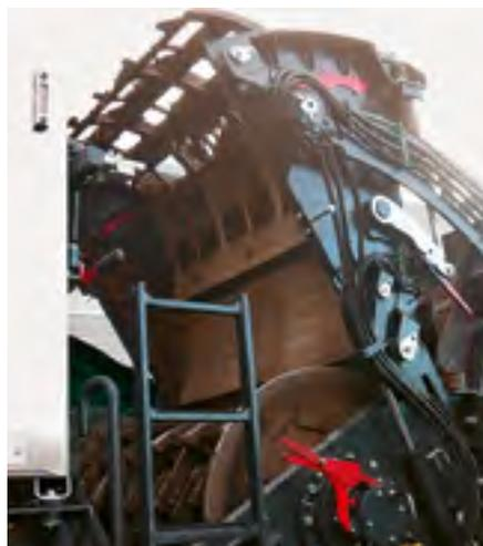
**Das hydraulisch klappbare Rotorgehäuse bietet eine sehr gute Zugänglichkeit zu Hacktrommel und Siebkorb.**
