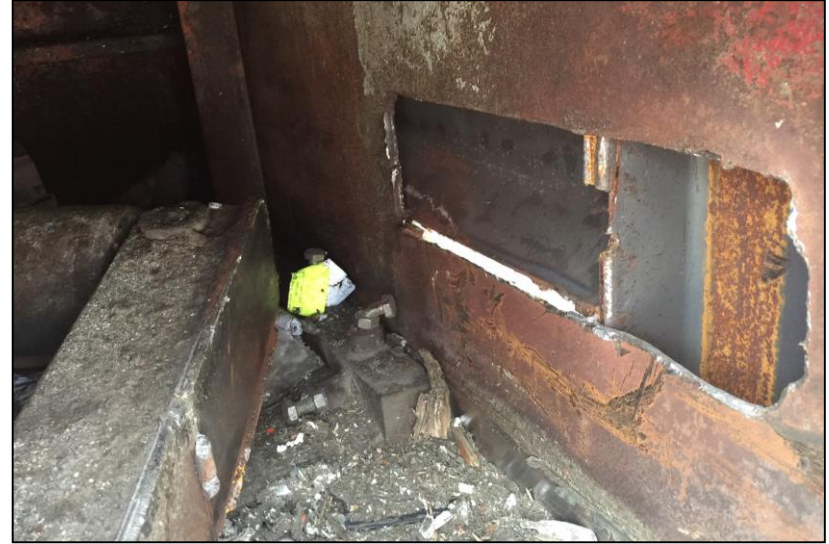
Totalschaden im Pressraum
