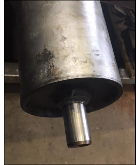
Aufbereitung einer Förderband-Tragrolle in der Werstätte
