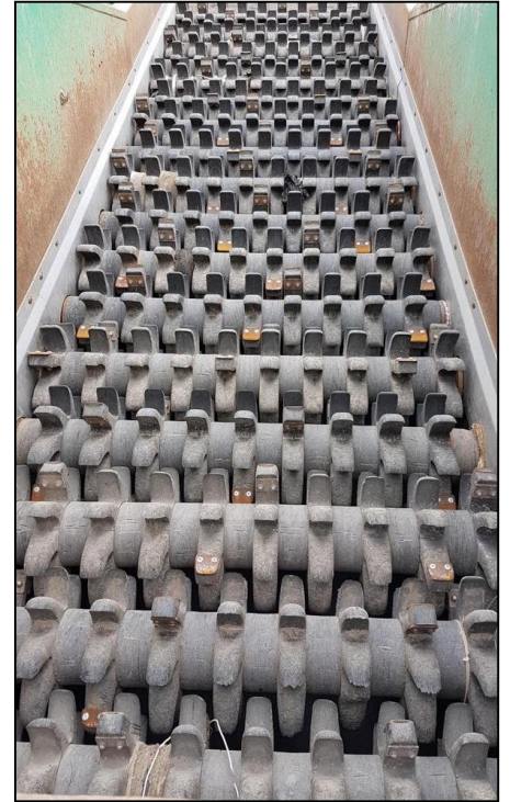
Zustand der Siebdecks (Feinsieb links / Grobsieb rechts) vor der Revision
