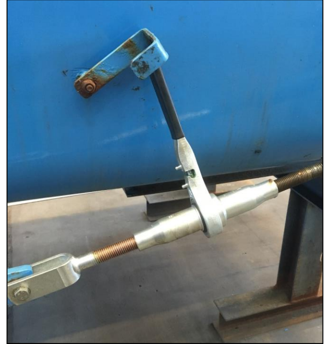
Austausch der Türverschluss-Ratsche an der Entleertüre
