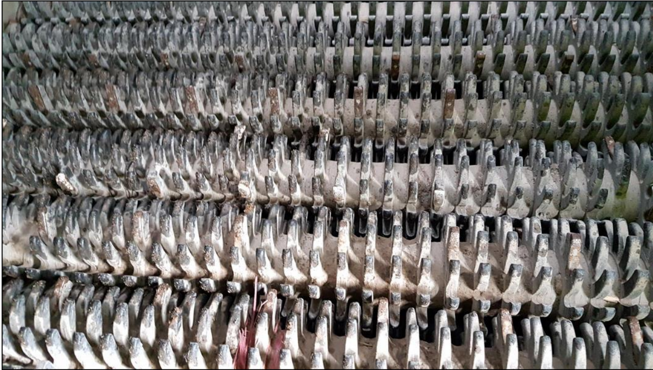
Zustand der Siebdecks (Feinsieb links / Grobsieb rechts) vor der Revision
