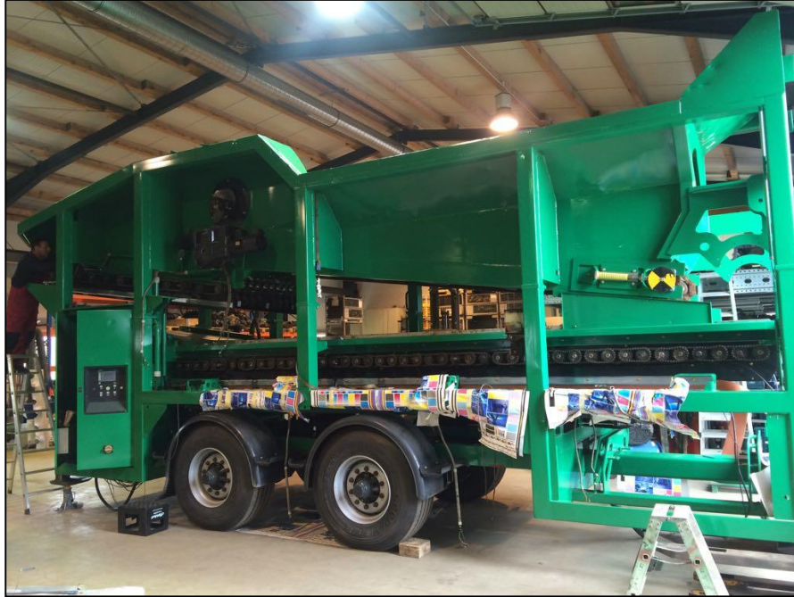
Komplette Neulackierung des Maschinenrahmens
