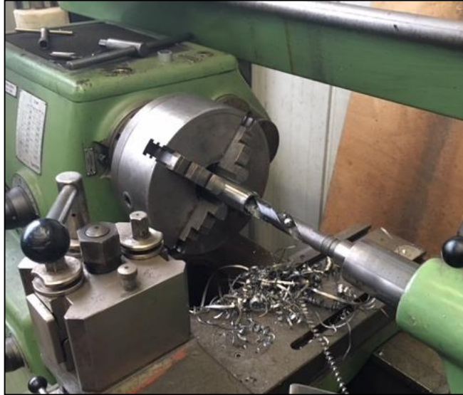
Aufbereitung einer Förderband-Tragrolle in der Werstätte
