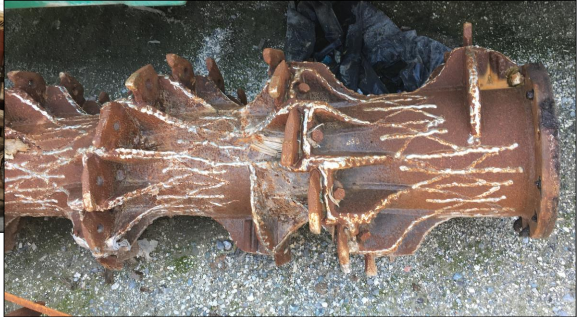
Rostige Zerkleinerungswelle mit verschlissenen Zähnen
