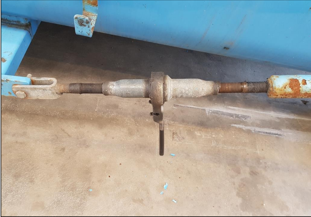
Austausch der Türverschluss-Ratsche an der Entleertüre
