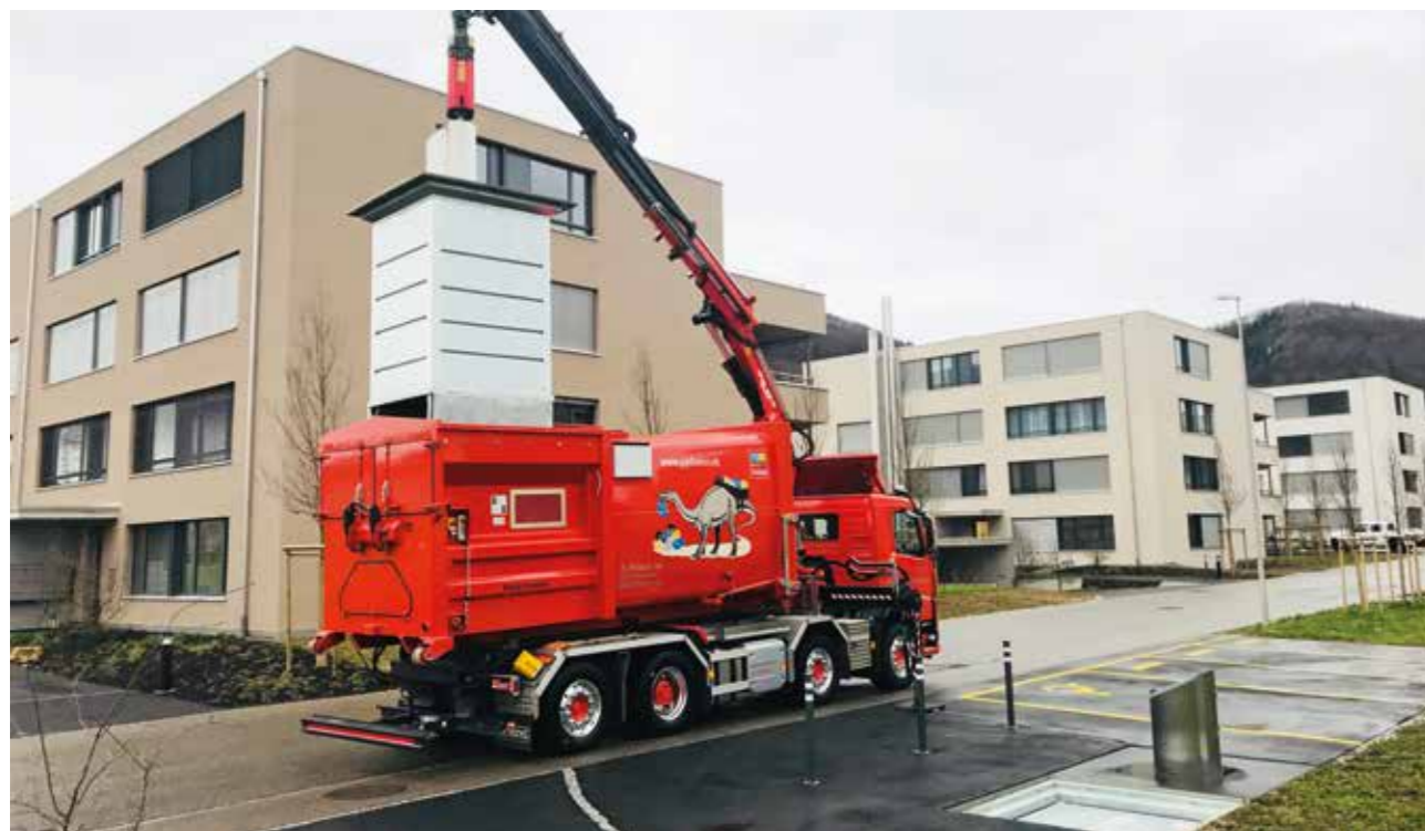
«Un compacteur sur un camion est la solution optimale pour vider les conteneurs souterrains», déclare l'exploitant Peter Pfister.
