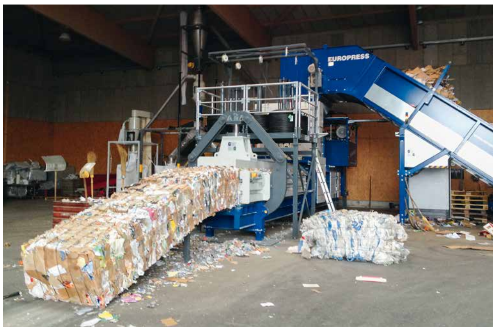
Presse horizontale à ballots de 80 tonnes (puissance de compactage) pour des matériaux tels que du carton, des pellicules, du PET ou d'autres matériaux synthétiques.
