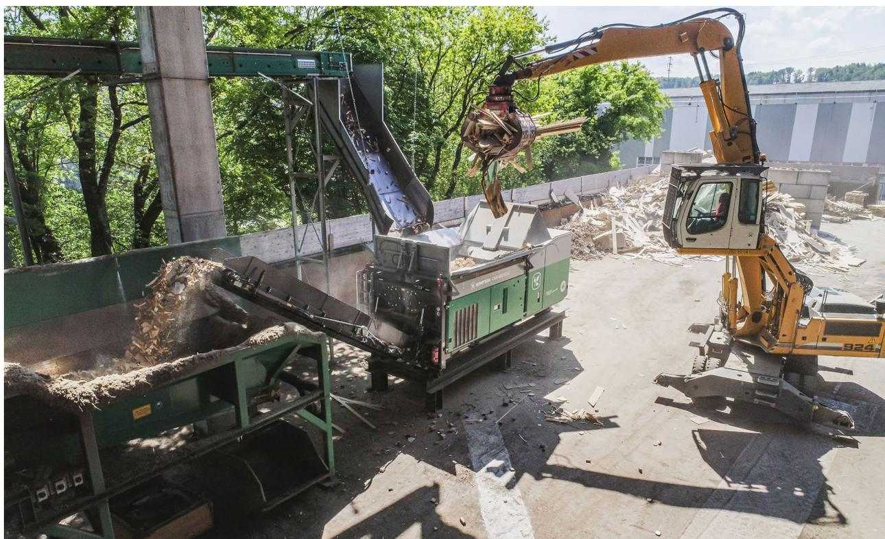
*Nach Zerkleinerung, Siebung und Metallabscheidung ist der Brennstoff optimal für die Nutzung in Biomasseheizkraftwerken vorbereitet. Falls bei den Maschinen doch einmal etwas sein sollte, ist GETAG, Komptech-Vertriebspartner für die Schweiz, immer sofort zur Stelle.*
