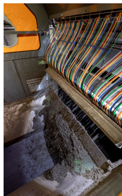
Düsen und Sensoren trennen Fremdstoffe präzise vom Gärgut
